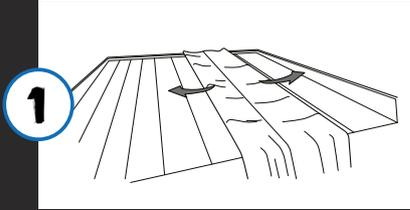
1 EPDM-Bahn auf das Dach bringen und ausbreiten. Kann im Vorfeld auch als provisorische Dachabdichtung genutzt werden.
