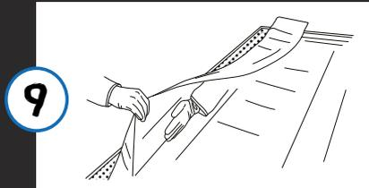
9 Die Randbereiche mit flacher Hand von innen nach außen bis in die Kehle anarbeiten und anschließend an der Blende bis zur Oberkante hocharbeiten.
