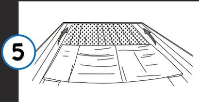
5 Die EPDM-Bahn möglichst faltenfrei aus der Mitte heraus in die noch nasse Klebefläche zurückarbeiten. (Eine Abluftzeit entfällt!)
