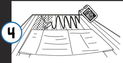
4 **Flächenkleber Bluetek** in Schleifen nur auf dem **Holzuntergrund** auskippen und mit der Rolle gleichmäßig verteilen.
