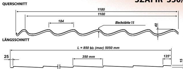
\*- bei Abmessung des hinteren Falzes > 125 mm weist die Blechtafel das letzte Profil nicht auf
