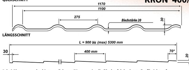
\*- bei Abmessung des hinteren Falzes > 70 mm weist die Blechtafel das letzte Profil nicht auf
