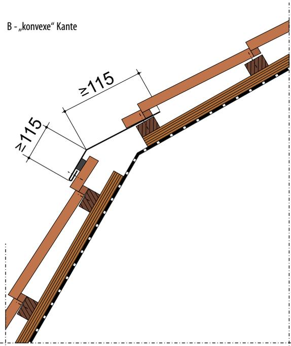
**ACHTUNG!** Alle Verblechungen als Schutz für die Dachflächen werden in „Kantenstreifen“ des Daches eingebaut, wo die höchsten Belastungen durch Windsog auftreten – daher sind sie alle 33 cm zu befestigen.
